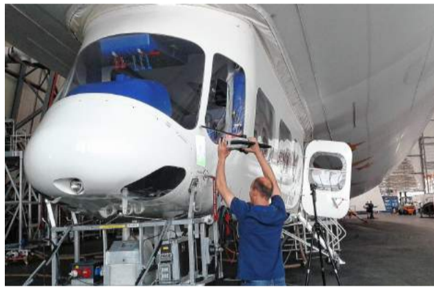
Der Scanner im Einsatz: Softwareentwickler Hans Woerner mit „dentCHECK“ im Einsatz am Zeppelin NT. BILD: ERIK KLAAS
